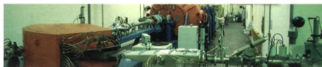
Figur 3. Acceleratoren til ^{14}\text{C} -målinger på Aarhus Universitet.
