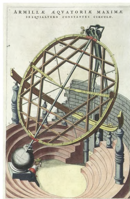
Figur 14. Den store armille i Stjerneborg. Dens skala i messing har en radius på 136 cm hvorved 1' = 0,40 mm og instrumentet anvendes til måling af deklinationer.
