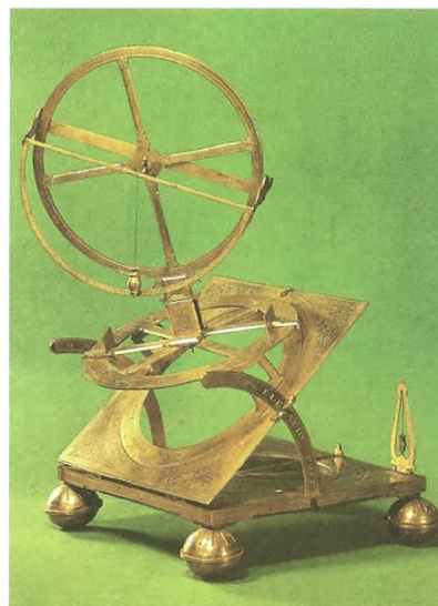
Figur 4. Torquetum – dette apparat kunne måle i de tre koordinatsystemer: horisontal, ækvatorial og ekliptika. Fremstillet i Prag ca. 1590. Fra [15].
