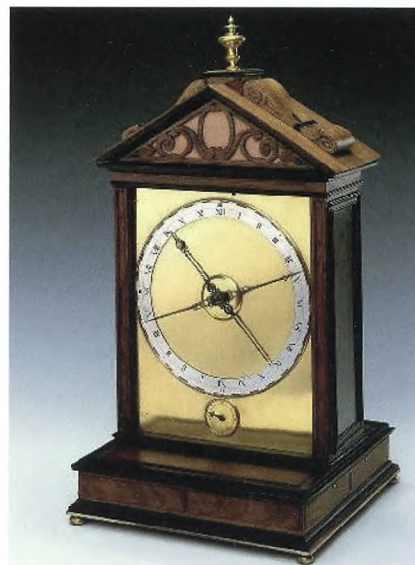
Figur 8. Observatoriumsur med krydsslagshæmning, automatiseret optræk og savtandsur svarende til Kassel observatoriets sekundur fra 1585. Fremstillet af Jost Bürgi i Prag 1625. Fra [12].
