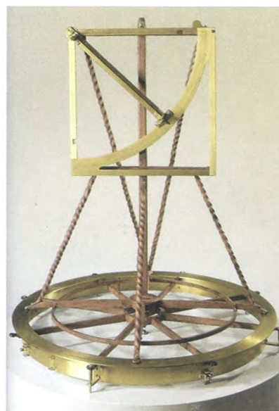
Figur 6. Kvadrant med 40 cm radius brugt i Kassel på Landgrevens observatorium fra 1560 til hans første katalog. Den findes nu på museet i Kassel og kaldes “Wilhelmkvadranten”. Fremstillet af Baldewein. Fra [14].
