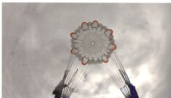
Figur 7. Vores hovedskærm i reefed tilstand. En line holder den delvist tillukket i bunden, så den ikke er foldet helt ud. Foto: Ahmad Rahman.
