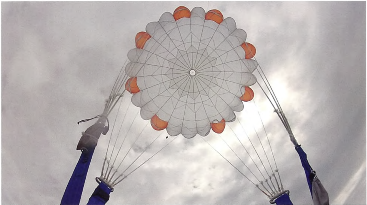
Figur 8. Vores hovedskærm fuldt udfoldet efter at linen er blevet klippet over. I bunden af skærmen kan man lige ane den ene af de to bokse, der indeholder timer og klippemekanismen. Foto: Ahmad Rahman.
