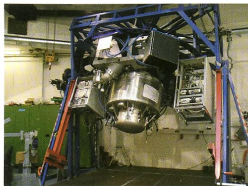
Figur 10. Afprøvning af X-shooter på en teleskop simulator hos ESO, Garching, juni 2008. Nederst ses den infrarøde spektrograf og over den en af de optiske spektrografer. De to store kasser på hver side af den infrarøde spektrograf indeholder elektronik.
