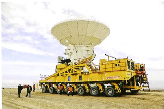
Figur 4. Otto ankommer til AOS med den første antenne efter en køretur på 28 km fra OSF (23. september 2009). Køretøjet kan styres både fra førerhuset nederst i højre side og med en håndholdt styrepult, her båret af manden med seletøjet og gul hjelm. Det har 14 par individuelt styrbare hjul med hver to dæk og kan vende rundt på stedet. Målene på køretøjet er 10 m × 20 m × 6 m og massen er 130 tons.
