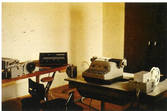
Figur 4. GIER-datamaten fra 1962, den første på et dansk universitetsinstitut. Elektronikken er indbygget i skabet til højre. Fra venstre ses papirstrimmellæser, kontrolbord, skrivemaskine til in- og output og papirstrimmelhuller.
