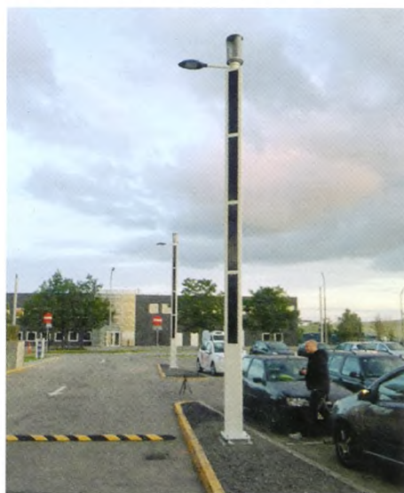
Figur 7. Der er to prototyper af konceptet opstillet i "Danish Outdoor Lighting Lab" i Albertslund (DOLL visitor center, Naverland 2, 2600 Glostrup). Prototyperne er langt fra af et udseende i stil med dem, der er realiseret grafisk i 1. halvdel af projektet, men de illustrerer det system, der skal til for at oplyse lokalgader i København, og vi var nødt til at bruge en masse standardkomponenter.
