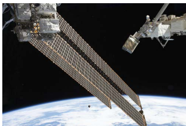
Figur 1. Delphini-1's udsendelse fra den Internationale Rumstation den 31. januar 2019. Satellitten blev udsendt fra NanoRacks robotarm, som ses øverst til højre, og Delphini-1 ses lige under solpanelet i bunden af billedet (NASA, NanoRacks).
