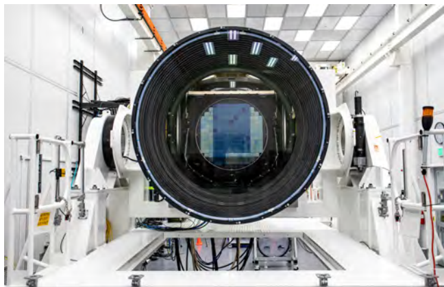
Figur 3. LSST-kameraet med dets 1,5 m brede indgangslinse og det 65 cm brede fokusplan. Foto: Jacqueline Ramseyer Orrell/SLAC National Accelerator Laboratory.
