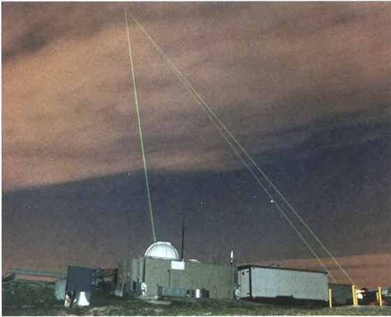
Figur 7. Der holdes løbende øje med afstanden til Månen ved hjælp af laserstråler, her fra Goddard Geophysical and Astronomical Observatory (NASA).
