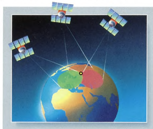
Figur 9. Princippet i det Globale Positionerings-System (GPS). De tre satellitter giver modtagerens præcise position i deres signalers fælles skæringspunkt med Jordkloden. Illustration: Troels Marstrand.
