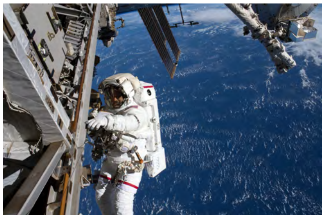
Figur 2. NASA-astronaut Ricky Arnold på EVA vedligeholdelse udstyr på ISS's store bjælke. Bemærk Canada 2.0-robotarm og ASIM-instrumenterne øverst til højre. Foto: NASA/Andrew Feustel (CC BY-NC-ND 2.0 DEED).
