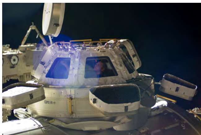
Figur 6. Oleg Kotov i Cupola. Bemærk de store beskyttelsesskodder og mange gule håndtag til EVA'er. Foto: NASA Johnson Space Center (CC BY-NC-ND 2.0 DEED).
