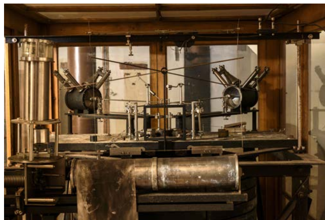
Figur 3. Flere af de oprindelige instrumenter står stadig på den seismiske station i København bl.a. den tonstunge Wiechert Horisontalseismograf. Foto: Casper Brogaard Højer.
