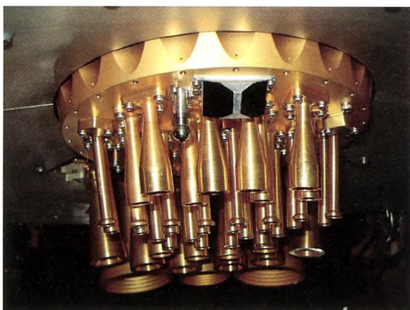
Figur 8. Arrangementet af detektorerne i fokalplanen. Øverst ses en tegning hvor de forskellige horn til de forskellige frekvenser er placeret. Nederst ses et nærbillede af HFI-hornene, LFI-hornene kan ses i baggrunden.
