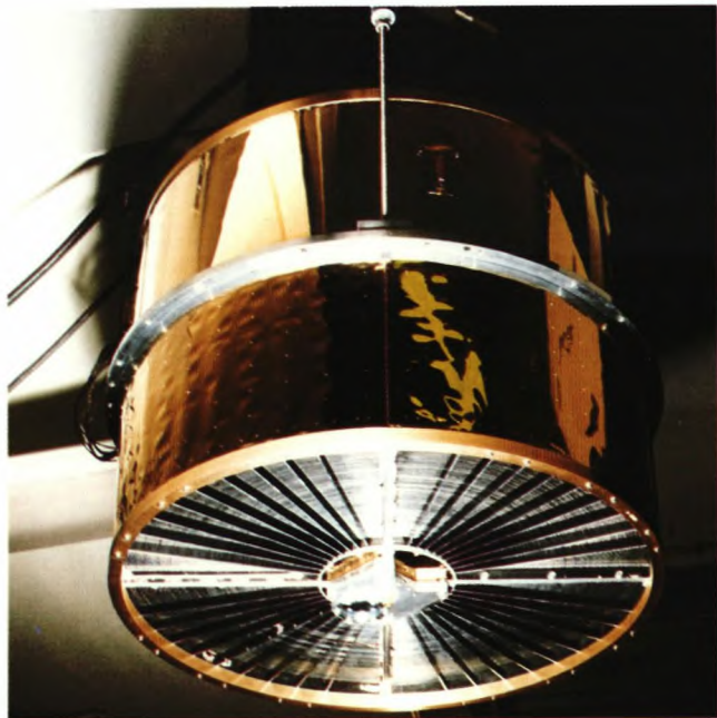
Figur 3. Et af XSPECT spejlmodulerne. (diametren af spejlsystemet er 60 cm). De tynde aluminiumsspejle er placeret så tæt som muligt, dog uden at skygge for hinanden. Som det ses bliver spejlene fastholdt i radielt placerede egre.
