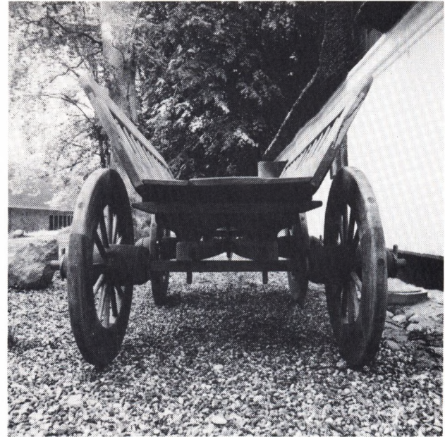
Fig. 12. Vognen set bagfra med vognkassen monteret. Bemærk at den høje undervognskonstruktion holder kassen fri af hjulene. Foto: P. Dehlholm.
