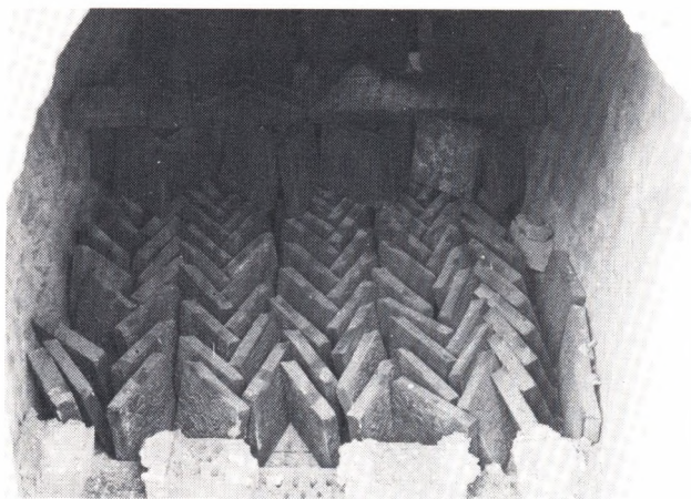
Fig. 7. Stabling af fliser til glasering.
