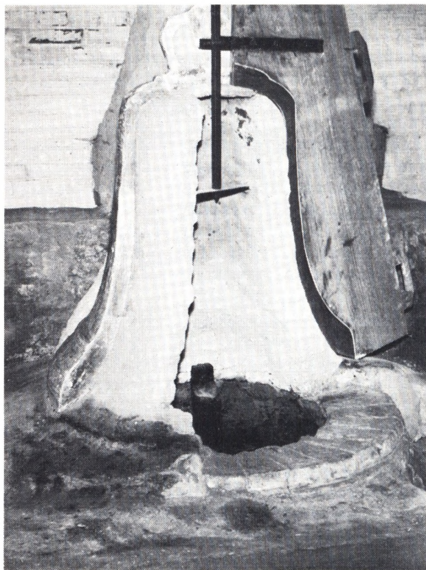
Fig 16. Klokkestøbningsgrube med rekonstrueret støbeform og skabelon i Vries kirke, Holland. Foto André Lehr.
