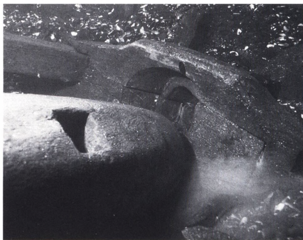
Fig. 14. Styrbords side af ankerspillet. I forgrunden selve spiltromlèn med huller for håndspagerne. Tromlèn er gledet ud af sit leje, og låseklodsen ses tydelig i billedet. Foto: Sven Erik Jørgensen, 1987.
