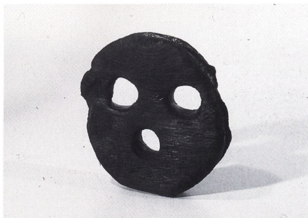
Fig. 27. Jomfru fundet fremme ved forskibet. Jomfruer som denne har sammen med taljereb været anvendt til at stramme skibets vanter – dvs. afstøtning af masten – op med. Foto: Henrik Jørgensen, Vikingeskibshallen, 1990.
