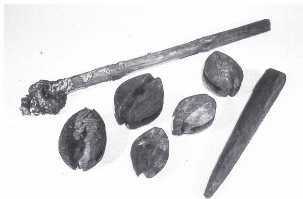
Fig. 8. Forskellige blokke, en tjærekost og en pren fundet ude i forskibet af vraget. Genstandene stammer formentlig fra skibets »kabelrum« – et aflukke, hvor man traditionelt opbevarede forskellige former for reservegods. Foto: Henrik Jørgensen, Vikingskibshallen, 1990.
