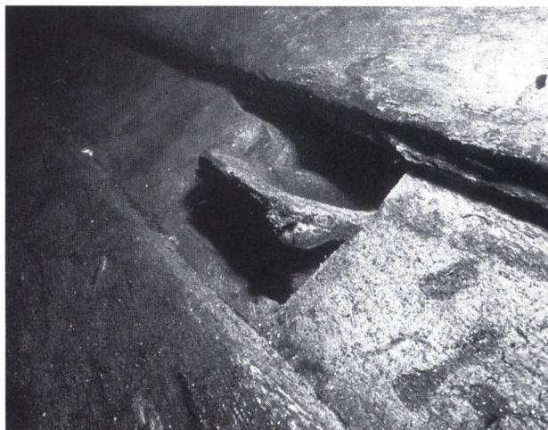
Fig. 16. Et af de fire spygatter i bagbords side, der har afledt vandet fra skibets hoveddæk. Spygatterne løber ud imellem første og andet barkholt – de kraftige planker, der ses på billedet. Foto: Sven Erik Jørgensen, 1987.
