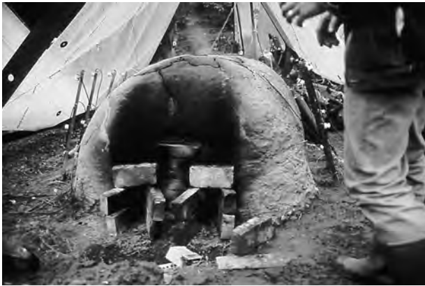
Fig. 5. Temperaturfølerne er placeret på hegnspæle langs begge sider af Barmerovnen. Indsætningsåbningen bruges som aftræk under brændingen. Trækken reguleres ved opstabling af mursten.
