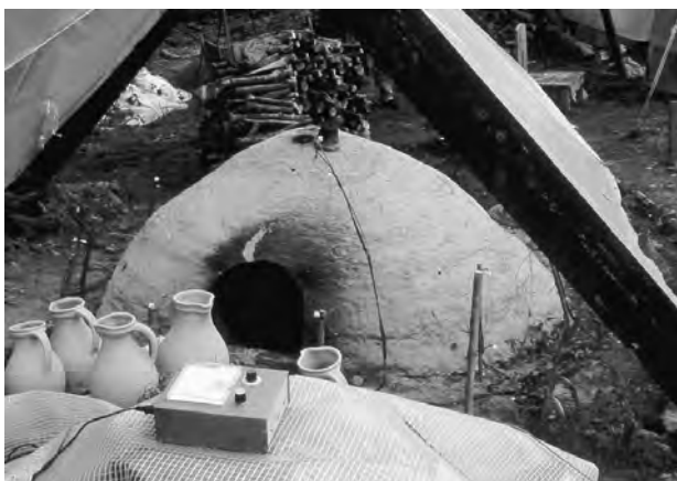
Fig. 7. Kander klar til indsætning i Kragelundovnen. I forgrunden simpelt instrument til måling af temperatur i ovnen. Alternativ til det mere komplicerede system.
