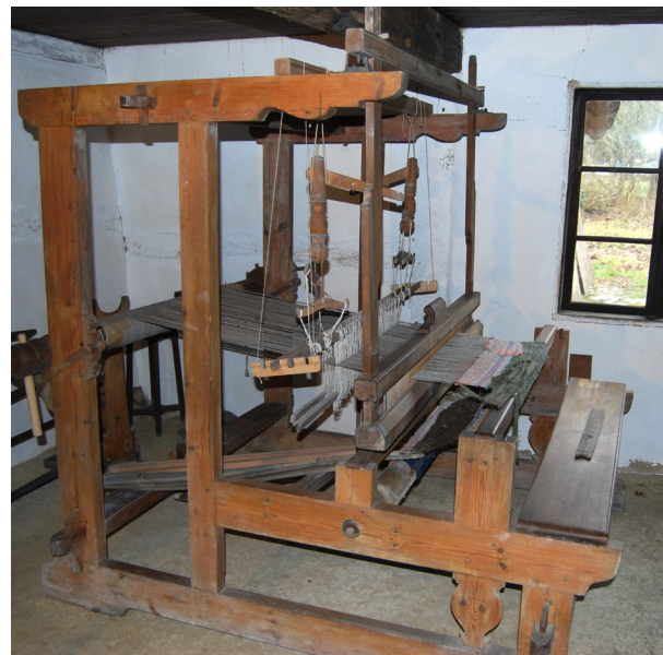
Fig. 11 og 12: Profiltegning og foto af sidestykke af type 4. Typen er udskilt fordi den har dobbelt bagstander. Begge bagstandere går fra bund til top. Den fotograferede væv, som profiltegningen er baseret på, er væv nr. 17.378 fra Dörrödhuset på Frilandsmuseet. Tegningen er udført af Helene Lilje Jensen. Foto: Ditte Kröner.
