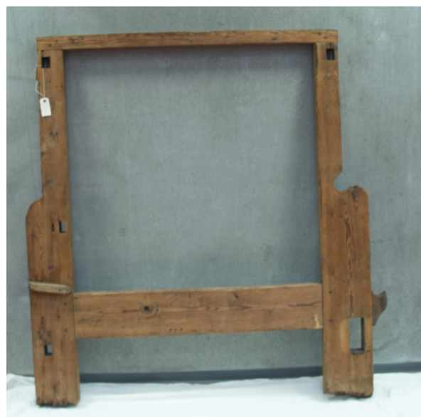
Fig. 9 og 10: Profiltegning og foto af sidestykke af type 3. Typen er udskilt pga de asymmetriske standere. Den fotograferede væv som profiltegningen er baseret på er HAM 0055 fra Museum Sønderjylland. Fotograf Ditte Kröner. Tegningen er udført af Helene Lilje Jensen.
