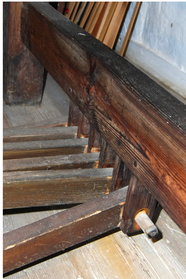
Fig. 2: Trampfæstet monteret på den nederste, bagerste slå. En gaffel med plads til 5 tramper, men har en 6. trampe placeret længst ude til venstre i billedet.
