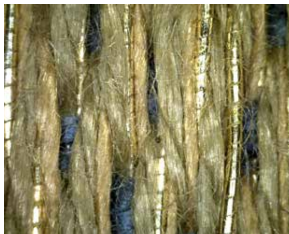
Fig. 3: Mikroskop-billede af en væveprøve til Ryde Kirke. De lodrette tråde er islætten og man kan se, hvordan to nuancer guld er blandet med ægte guldtråde af den type, hvor en såkaldt sjæl er omviklet med guld. De blå tråde er trenden.
