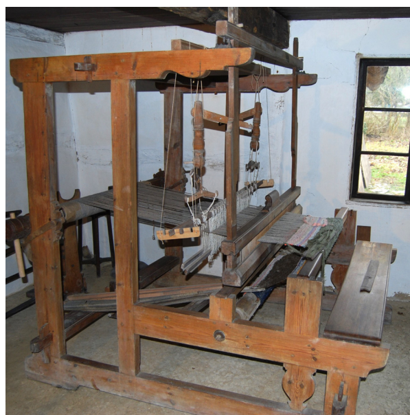
Fig. 11 og 12: Profiltegning og foto af sidestykke af type 4. Typen er udskilt fordi den har dobbelt bagstander. Begge bagstandere går fra bund til top. Den fotograferede væv, som profiltegningen er baseret på, er væv nr. 17.378 fra Dörrödhuset på Frilandsmuseet. Tegningen er udført af Helene Lilje Jensen. Foto: Ditte Krøner.
