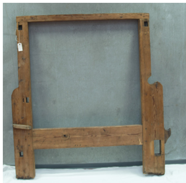
Fig. 9 og 10: Profiltegning og foto af sidestykke af type 3. Typen er udskilt pga de asymmetriske standere. Den fotograferede væv som profiltegningen er baseret på er HAM 0055 fra Museum Sønderjylland. Fotograf Ditte Krøner. Tegningen er udført af Helene Lilje Jensen.
