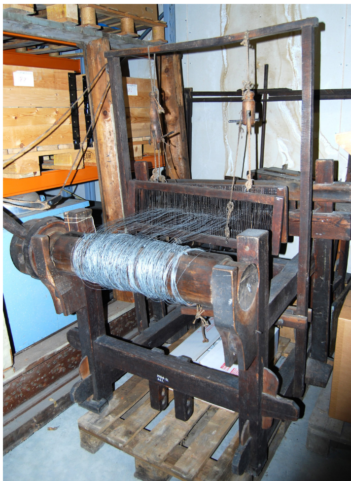
Fig. 20 og 21: Profiltegning af sidestykke af type 8. Fotoet viser et andet eksempel på en væv med midtstander. Typen er udskilt, da selve konstruktionen minder mere om et kasseformet understel. Det stående slagbord muliggør en meget spinkel overbygning, der kun skal bære selve det skeldannende system. Profiltegningen er baseret på væv nr. OKM S065x0007 fra Museum Vestsjælland og fotoet gengiver væv nr. 1450:51 fra Den Gamle By. Tegningen er udført af Helene Lilje Jensen. Foto: Ditte Krøner.
