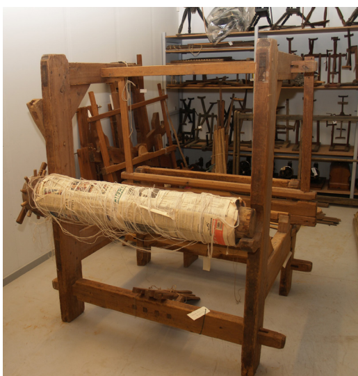
Fig. 16, 17 og 18: Tre eksempler på type 6 - bagstandervæv med hængende slagbord. Foto 1 er en svensk væv fra Tvillingegården på Frilandsmuseet. Fotograf Ditte Krøner. Foto 2 er en svensk væv, oprindeligt købt til landbrugsudstillingen på Ringsted Museum. Fotograf Kathrine Brandstrup. Foto 3 er en væv uden nærmere proveniens end at giver bor i Ejsing, fra Hjerl Hede. Foto: Flemming Lundholm.
