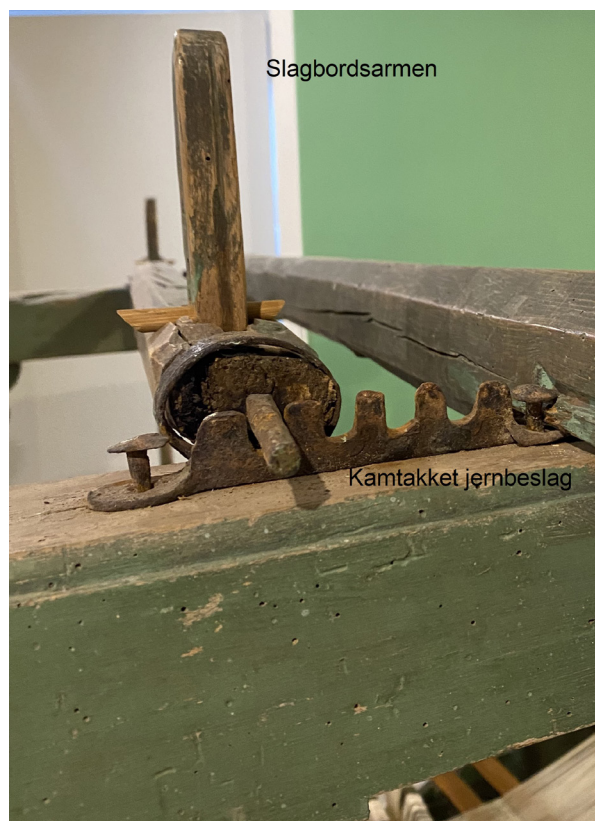
Fig. 2: Trampfæstet monteret på den nederste, bagerste slå. En gaffel med plads til 5 tramper, men har en 6. trampe placeret længst ude til venstre i billedet.
