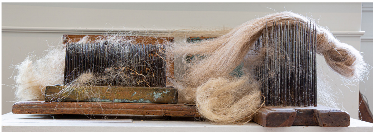
Fig. 2: To forskellige hegler med spindefibre. Heglerne er engelske hegler med lange tænder, som har været brugt, mens fabrikken endnu fungerede, men som nu er udstillede på Køng Museum og bruges i formidlingen. Foto: Poul Christensen 2021.
