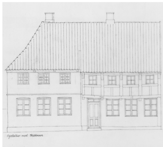
Fig. 3. Skibbroen 13, "Sælhunden". Opmålingstegning fra august 1966 af facaden mod Skibbroen før restaureringen. Opmålingen er foretaget af A. Bb. under Hans Henrik Engqvist og Karsten Rønnows tegnestue. Kilde: ASR 1493 T8A2.
