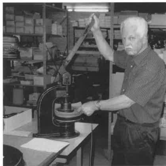
Fig. 15. Den nye ejer af urremmefabrikken, H.C. Tästensen, ved en af de gamle maskiner, en håndstansmaskine, som her benyttes til at fastgøre en metaldele på en båndende. Foto: Uwe Dall.
