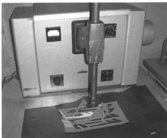
Fig. 9. Frekvenssvejsmaskine, der bruges til svejsning af plastikregntøj m.v. Maskinen anvendes stadig i industrien ved svejsning af kunststoffer f.eks. i fremstillingen af presenninger og plastposer.
