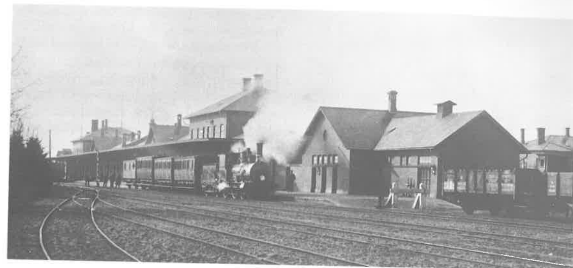
Fig. 6. Formiddagstog på Vedsted station forspændt sjællandsk lokomotiv litra Fs fra 1883. Oprangeringen med ret små kupévogne med sidedøre ind til hver kupé er typisk for Ribebanens første 50 år. Ca. 1914. Foto: Jens Bruun-Petersens arkiv.
