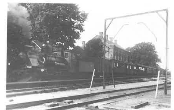
Fig. 11. Lokomotiv litra K med persontog, hovedsagelig oprangeret af toakslede persontog med åbne endeperroner. Ribe, ca. 1950. Foto: James Steffensen/Torben Andersens arkiv.
