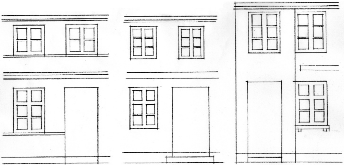
Fig. 16. Karakteristiske relationer mellem vinduer i under- og overetage i klassicistiske huse i Ribe.
